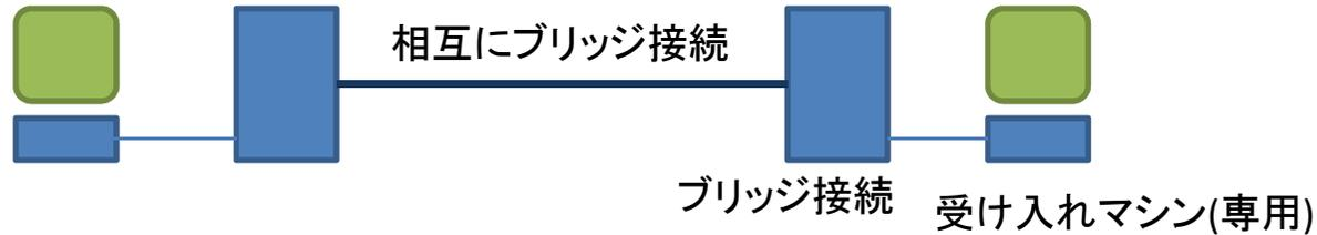
クライアント・読影センター相互に専用パソコン・LANを使用するシステム。専用ソフトによりデータを転送する。インターネット上は暗号化されて通信。導入コスト大、外部への漏洩リスク小。
